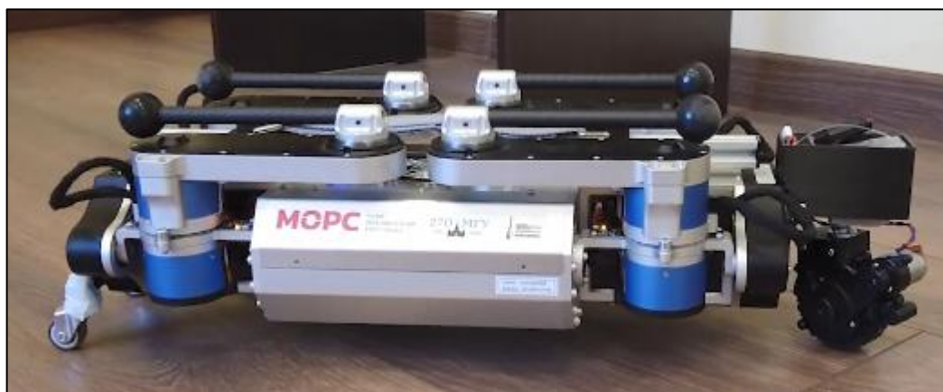
Рис. 5. Перспективное бюджетное решение для робота собаки классической кинематической схемы – гибридный движитель
