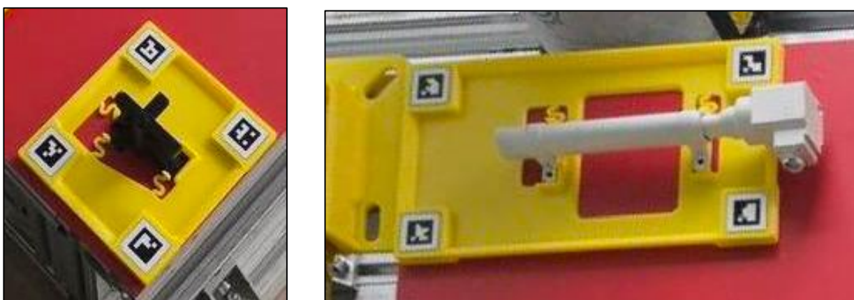
Рис. 2. Технологическая оснастка для ложементов с ArUco-маркерами
